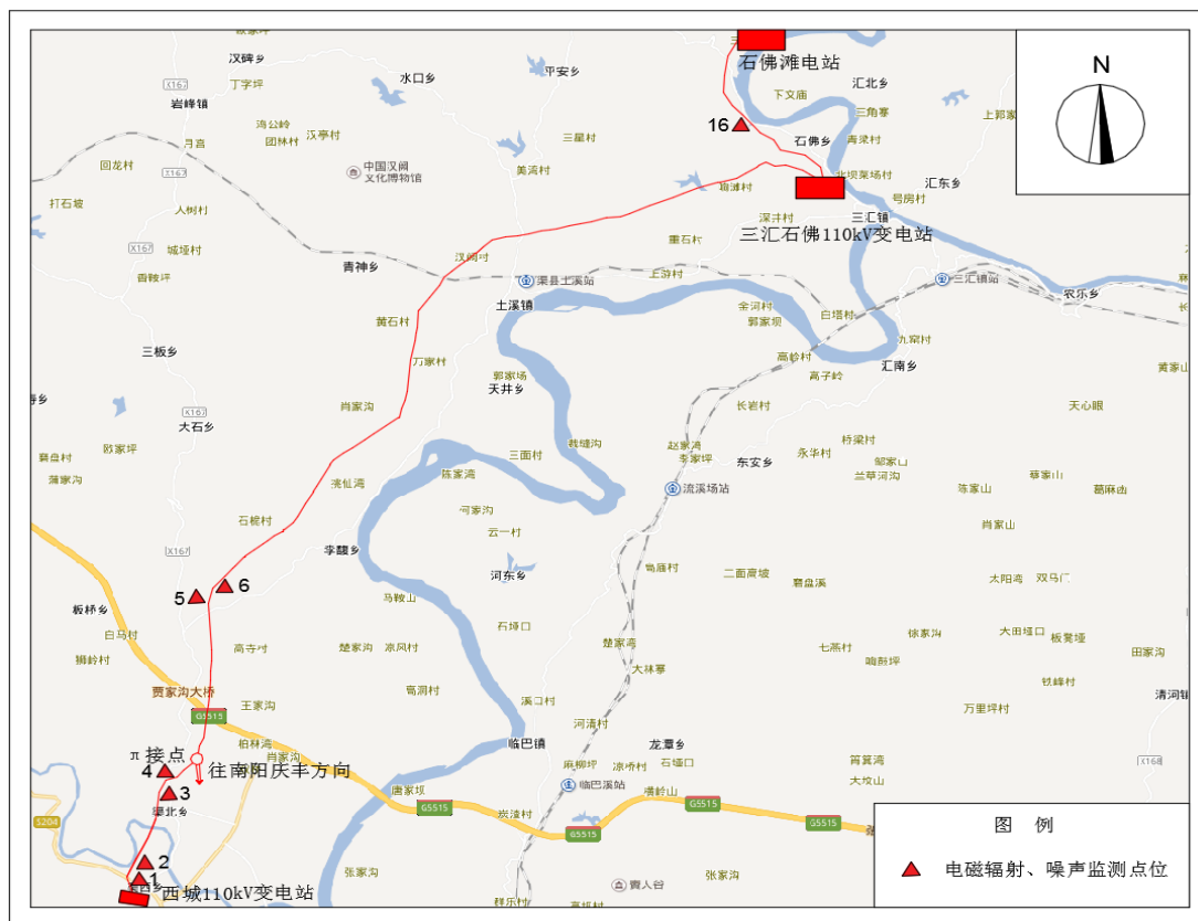
图 7-1 渠县西城至三汇石佛 110 千伏输变电工程输电线路监测布点示意图
